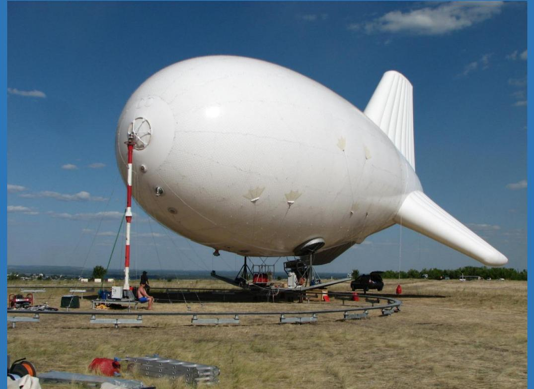
Для надёжной стоянки на базе без эллинга можно использовать круговой монорельс на винтовых сваях, как для привязных аэростатов.
