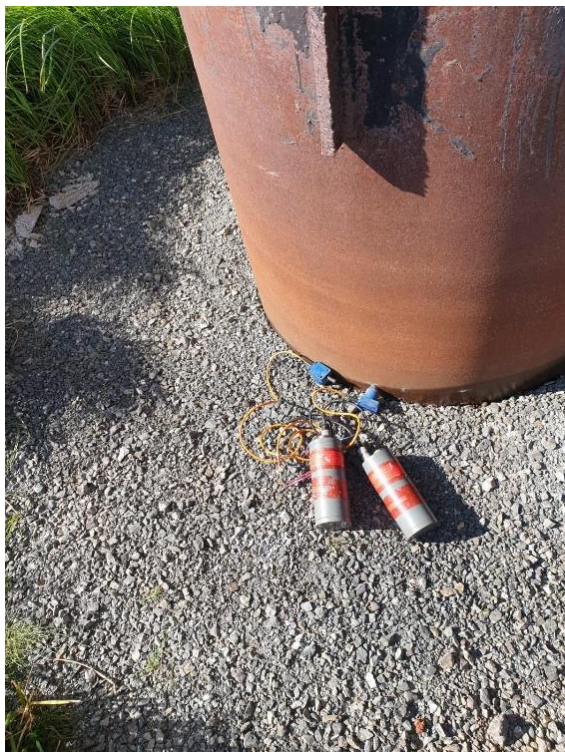
Процесс регистрации сигнала на сваях под мостом
