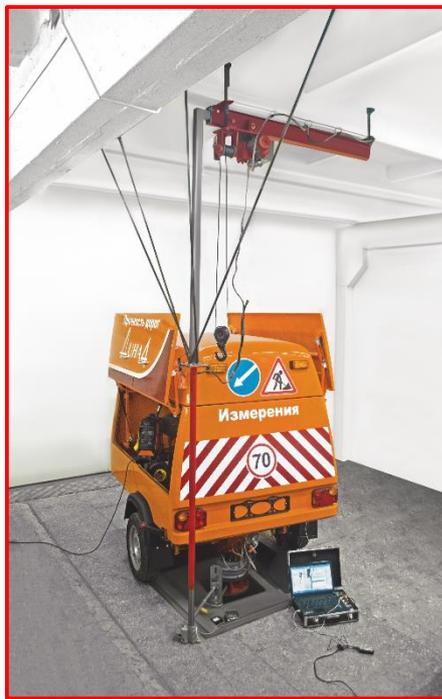
Для калибровки и метрологической поверки приборов, оборудовании, измерительных систем передвижных лабораторий используются как стационарные стенды, так и специальные ежегодно подготавливаемые полигоны.
