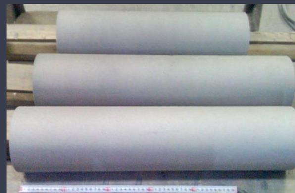
Ролики стана горячей прокатки (толщина покрытия 4 мм). Metallургическое оборудование ЗСМК, г. Новокузнецк.
