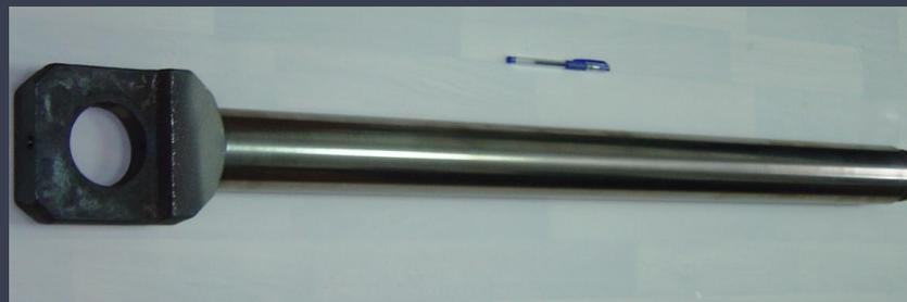
Шток гидроцилиндра после механической обработки (толщина покрытия 1 мм). Шахтное оборудование, г. Кемерово
