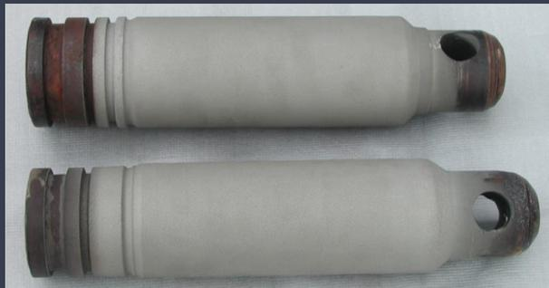
Шток гидроцилиндра без механической обработки (толщина покрытия 0,7 мм)
