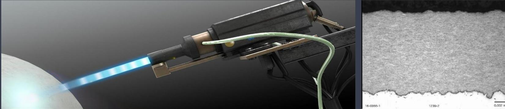
Сверхзвуковые гетерогенные потоки позволяют получать качественные покрытия с максимально возможными для газотермических методов адгезионными и когезионными характеристиками, минимальной пористостью
