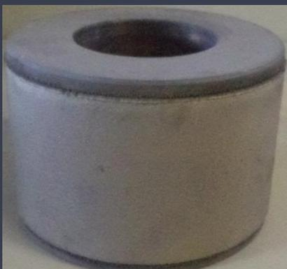
Ролик стана привалковой арматуры (толщина покрытия 3,5 мм).
