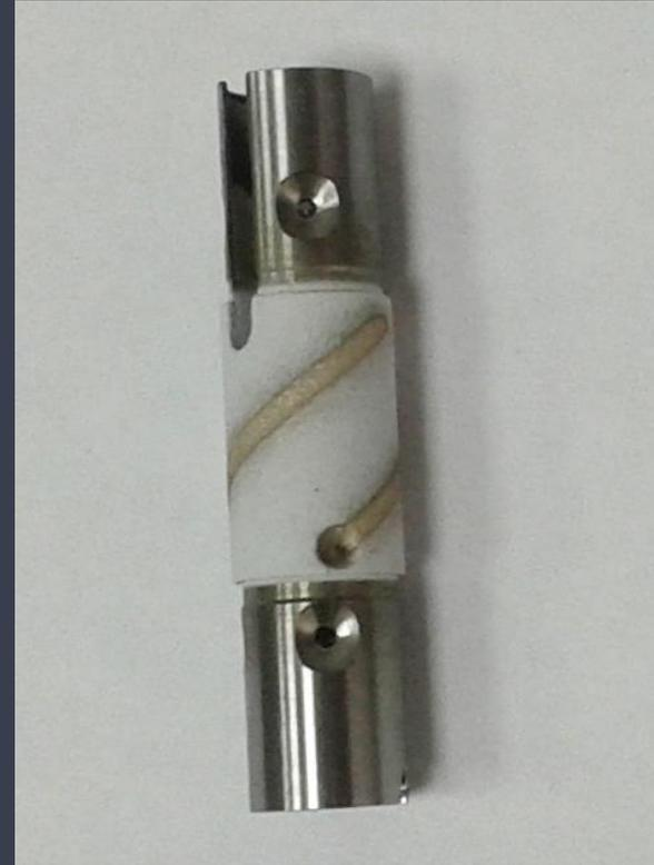
Диаметр антенны 7 мм. Основа – сталь. Изоляционный слой  $Al_2O_3$ .
