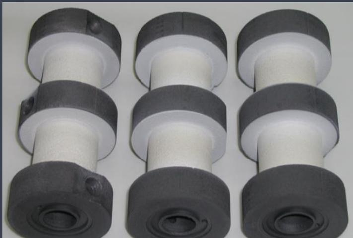
Углеродные проточные кюветы для проведения спектроскопического анализа высокотемпературных продуктов разложения в плазмохимическом реакторе.
