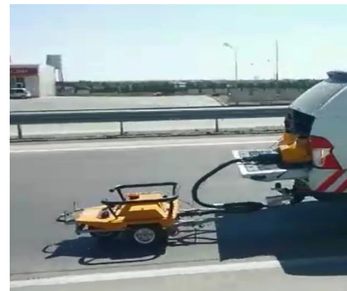
Общий вид передвижной лаборатории с установкой GripTester
