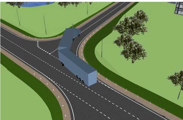
Моделирование поворота грузовика при съезде с основной дороги на примыкание
