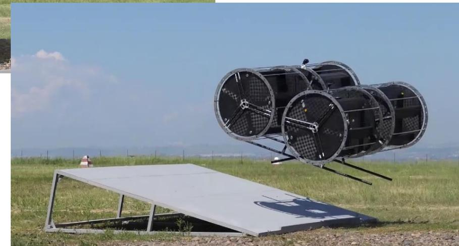
Под руководством специалистов ИТ СО РАН разработан, спроектирован, изготовлен и испытан БПЛА с циклическими двигателями
