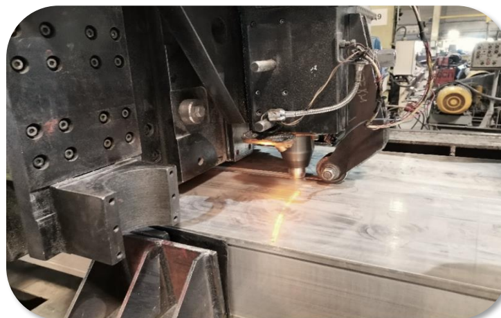
Применение технологии сварки трения с перемешиванием на ЗАО «Сеспель» г.Чебоксары.
