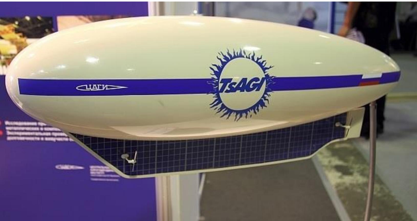
С 2008 г. ФГУП ЦАГИ разрабатывает свой вариант стратосферного дирижабля «ЦАГИ», но облик аппарата до конца не сформирован. За основу взят дирижабль с развитой килевой системой, на которой размещаются модули солнечных батарей, внешняя антенна и двигатели.
